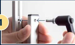
1 Setzen Sie die Unterlegscheibe auf den Klemmhebel und führen Sie diesen durch das Loch des Aluminiumprofils in den Nutenstein ein. Drehen Sie dann den Klemmhebel fest.
