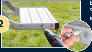
2 Entfernen Sie die vorhandenen Schrauben an der Trittstufe inklusive der Hülsen.
