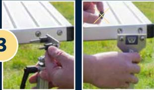
3 Setzen Sie die neuen Schrauben in den ANMIBER und stecken Sie die mitgelieferten Hülsen über die Schrauben. Für Trittstufen mit Senkkopfschrauben benötigen Sie die Hülsen nicht.
